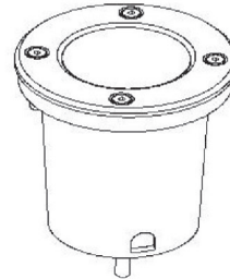
Installare la scatola esterna Install outer box
